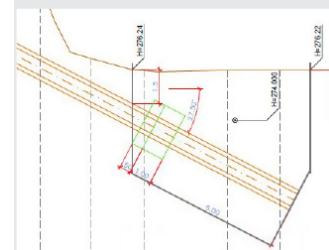
Längsprofil der Startbaugrube
